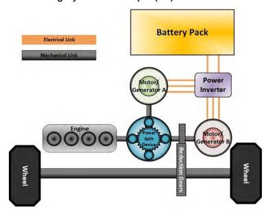
Figure 3-21: Strong Hybrid Power-Split (PS) Powertrain Architecture<sup>369</sup>
