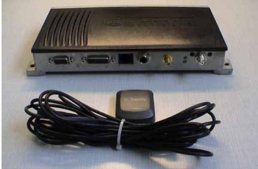
**Figure 25. Trimble Crosscheck GPS unit**
