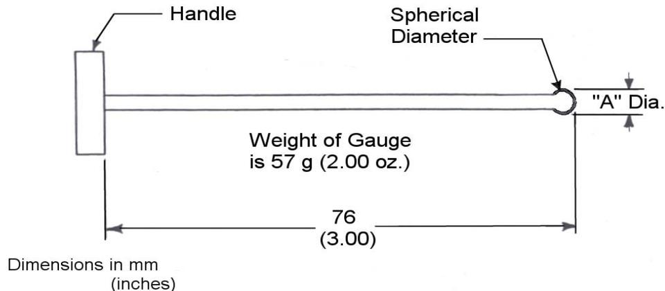
**FIGURE 5. CONSTRICTION TEST PLUG GAUGE**
