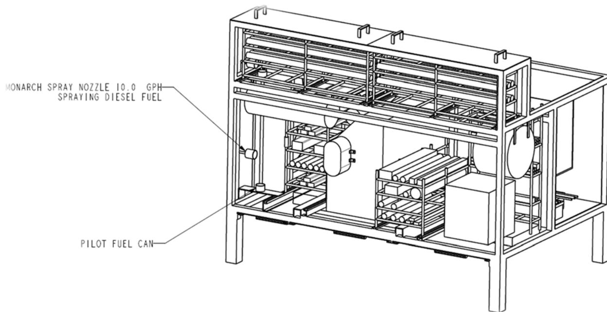
**Figure 22. Diesel Spray Fire Scenario
