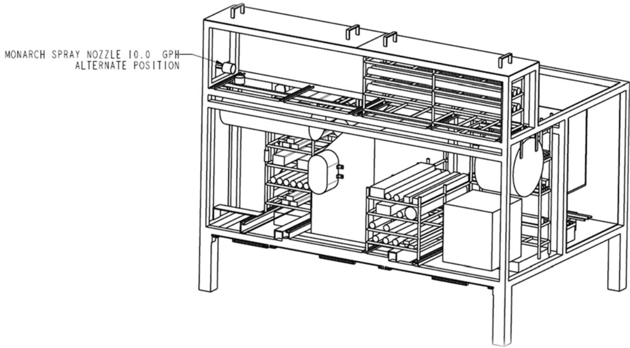
**Figure 23. Diesel Spray Fire Scenario
