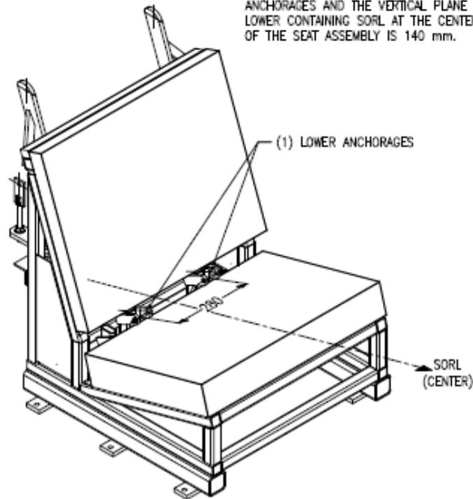
SEAT ORIENTATION REFERENCE LINE AND LOCATION OF THE LOWER ANCHORAGES OF THE CHILD RESTRAINT ANCHORAGE SYSTEM ON THE STANDARD SEAT ASSEMBLY
