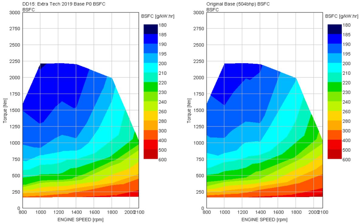
**FIGURE B1.1C BSFC COMPARISON OF 2019 BASE DD15 VS. ORIGINAL DD15
