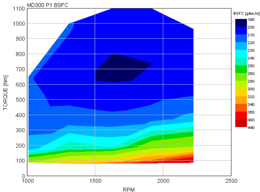
**FIGURE B2.2A BSFC MAP FOR COMBO PACKAGE 6**
