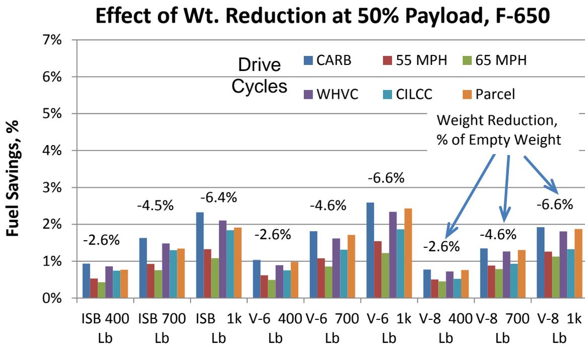
**FIGURE 3.7 EFFECT OF EMPTY WEIGHT REDUCTION ON F-650**
