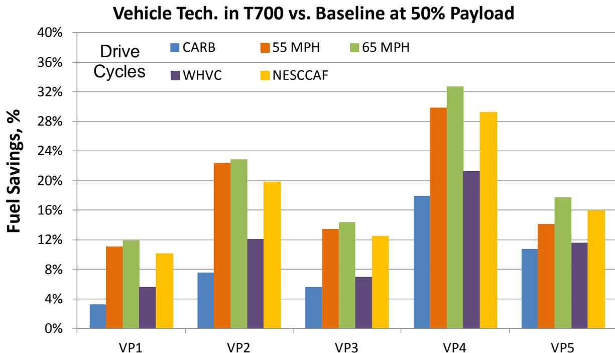
**FIGURE 2.3 T700 VEHICLE TECHNOLOGY COMBINATION FUEL SAVINGS RESULTS**
