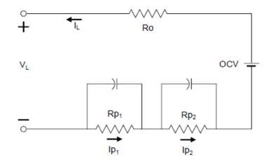
$1000*(OCV-V_L)/I_L = R = Ro+Rp_1*Ip_1/I_L+Rp_2*Ip_2/I_L$
