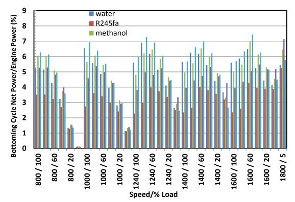
FIGURE B1.4C RATIO OF BOTTOMING CYCLE NET POWER TO ENGINE POWER OUTPUT FOR PACKAGE 3
