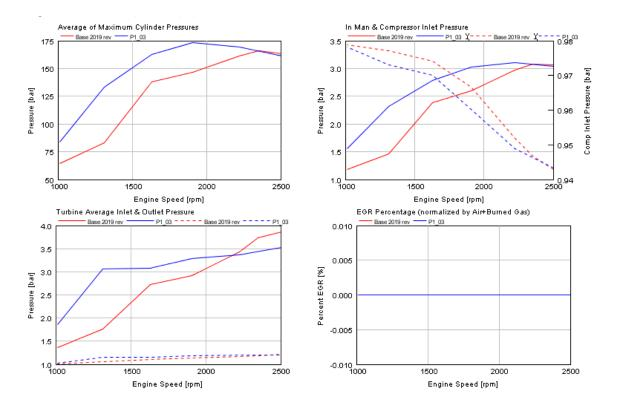
FIGURE B3.2C PACKAGE 11 FULL LOAD PERFORMANCE COMPARISON
