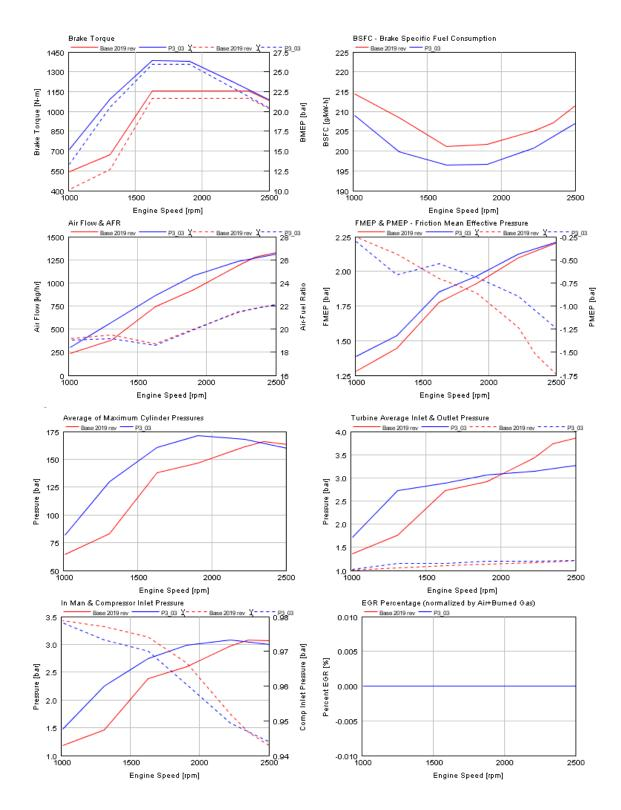
FIGURE B3.4C FULL LOAD PERFORMANCE COMPARISON FOR P13
