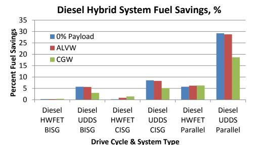
FIGURE D.2 DIESEL HYBRID SYSTEM FUEL CONSUMPTION REDUCTION IN PERCENT
