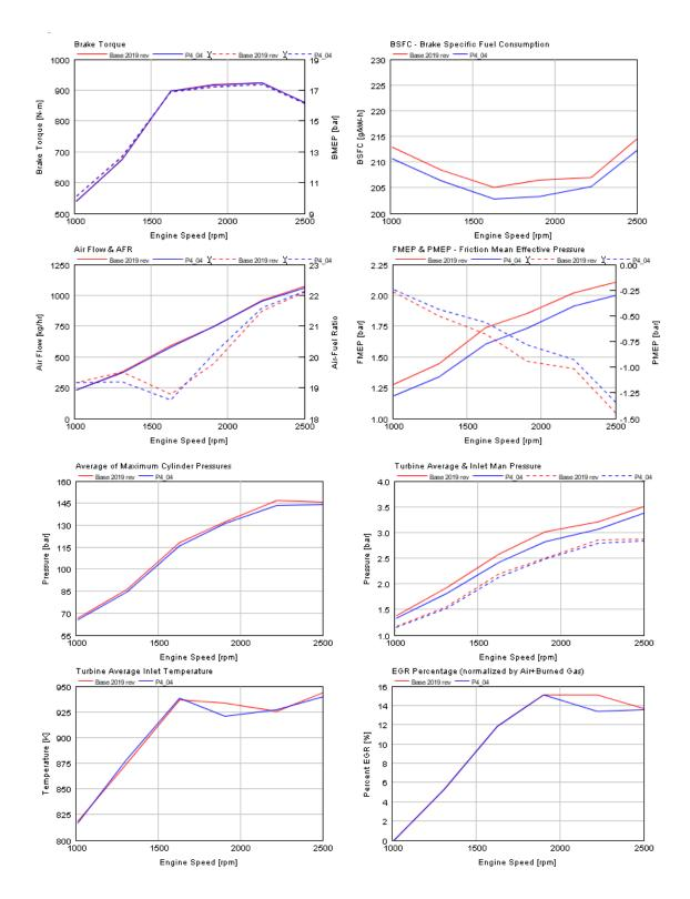
FIGURE B2.5C PACKAGE 9 FULL LOAD PERFORMANCE COMPARISON
