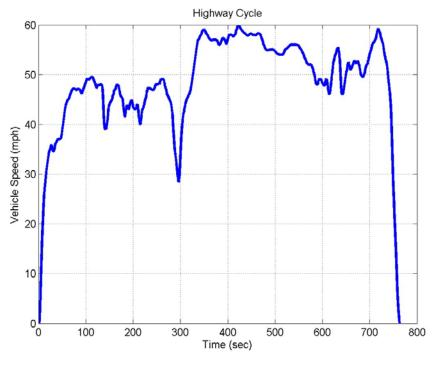
FIGURE C9 FTP-HIGHWAY DRIVE CYCLE
