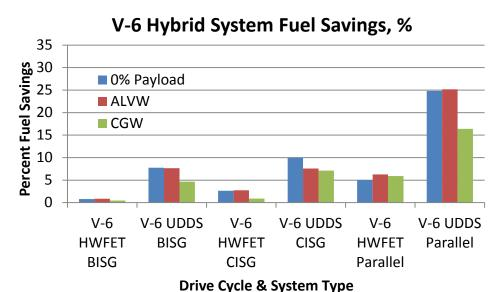
FIGURE D.3 V-6 GASOLINE HYBRID SYSTEM FUEL CONSUMPTION REDUCTION IN PERCENT
