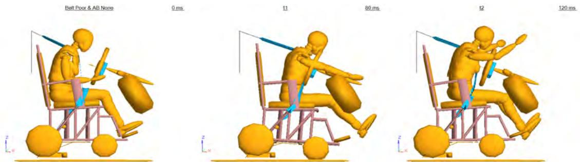
(d) - poor belt fit with no steering-wheel air bag
